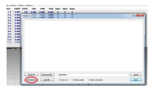
nel caso in cui, lo strumento sia correttamente connesso al PC, alla pressione del tasto "Send Break", si otterrà una risposta come nell'immagine sottostante (Nome e modello dello strumento, versione e stato attuale dello strumento)
