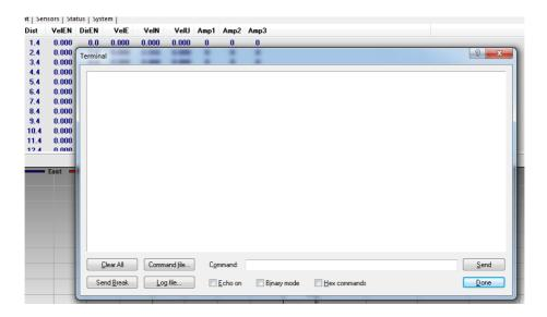
Premere sul tasto "Send Break" in modo da verificare l'effettiva connessione dello strumento via seriale
