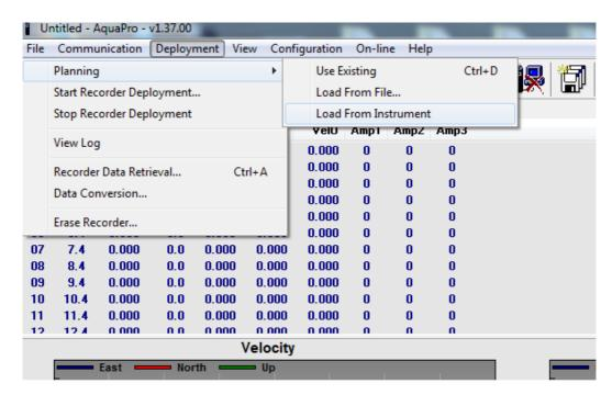
Si aprirà la schermata "Deployment Planning" con due schede, una "Standard" e una "Advanced" dove si potranno modificare vari parametri, come la frequenza di campionamento, l'intervallo di tempo ed i metodi di campionamento (tipo di coordinate da usare). Utilizzare queste due schede per programmare lo strumento e premere il tasto "Update", in modo da salvare i cambiamenti appena apportati nella memoria dello strumento.
