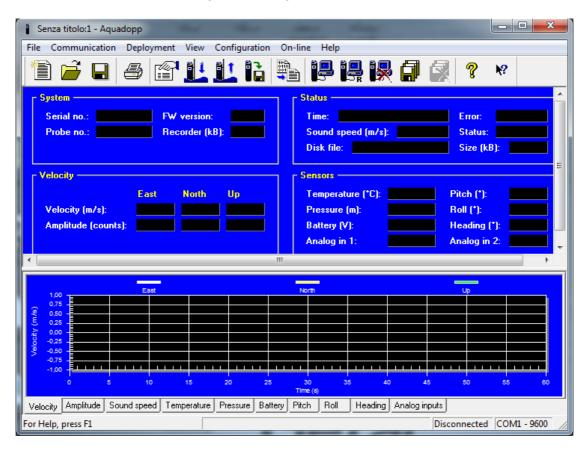
Qui di seguito vengono anche riportate le schermate ove sono visibili i parametri da configurare per un'acquisizione standard (1 dato al secondo). Ultimamente la bussola del correntometro ha smesso di funzionare, risulta pertanto obbligatorio settare il correntometro con le coordinate X-Y-Z anzichè EST-NORD-UP.
