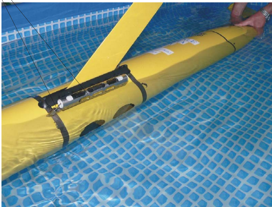
Fig. 6 I sensori del Glider posti sotto l'ala sono particolarmente delicati e non devono essere sottoposti a sforzi ed urti.
