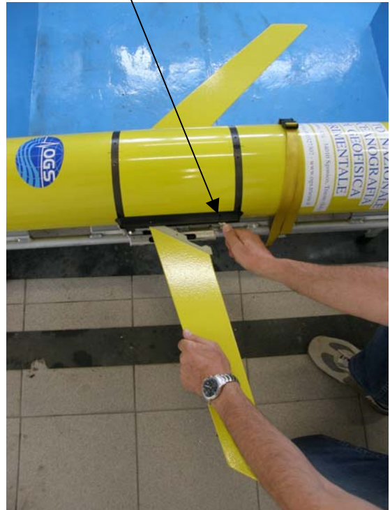
Fig. 13 e 14 Sgancio e aggancio delle ali (Wings). Le ali vanno montate poco prima di entrare in acqua e smontate durante il recupero, prima di issare a bordo il Glider. Durante queste operazioni prestare attenzione a non urtare i sensori (Fig. 6) sotto l'ala.
