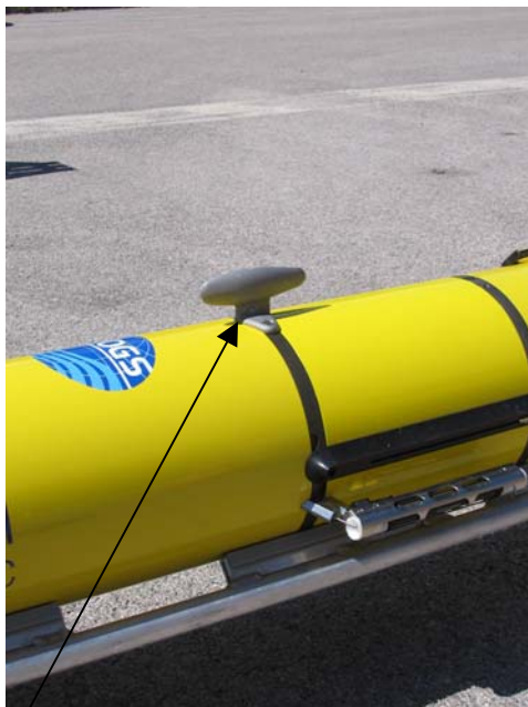
Fig. 3 Particolare del Gancio fissato sul dorso del Glider. Da utilizzare in fase di rilascio o di recupero per agganciare il "mezzo marinaio" o per fissare cime di sicurezza.
