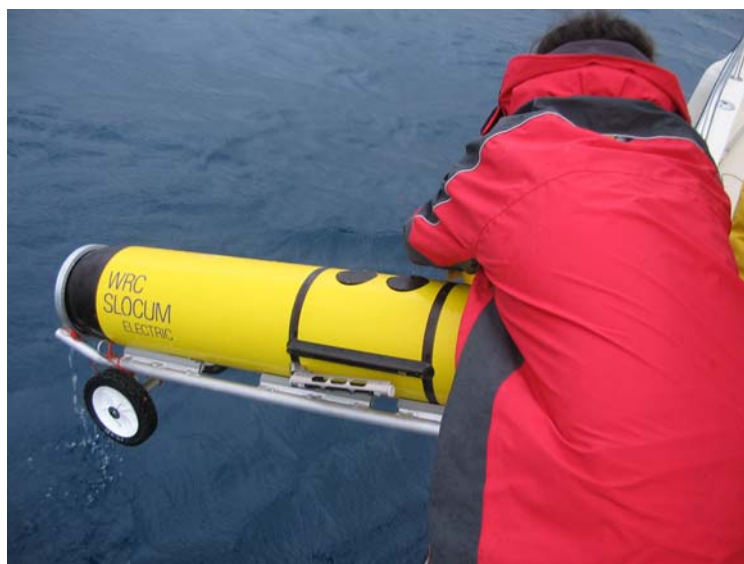
Fig. 12 Dopo aver sganciato le ali (vedi foto seguenti) facendo leva sul carrello si recupera il Glider. Appena possibile, fissare il Glider al carrello con l'apposita cintura e posizionarlo a bordo. L'operazione di recupero, richiede la sola attenzione di non urtare i sensori (Fig.6) sotto l'ala e il timone.
