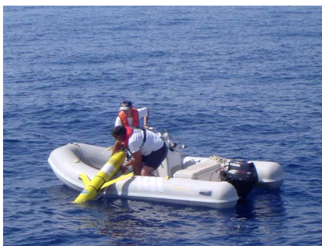
Fig. 9 Inclinando il carrello si fa scivolare il Glider in acqua reggendolo per il Braccio metallico del timone (come visualizzato in Fig. 4 e 5)
