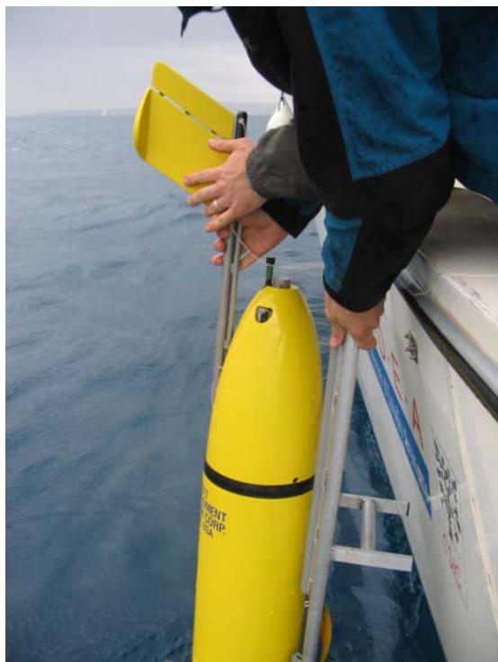
Fig. 11 Recupero del Glider con una piccola imbarcazione: dopo aver afferrato il Glider per il Braccio metallico del timone , posizionarlo in verticale ed infilare il carrello in acqua (con l'anello di prua montato!). Posizionare il carrello come in figura, quando la prua del Glider è appoggiata sull'anello di blocco del carrello, iniziare il sollevamento.
