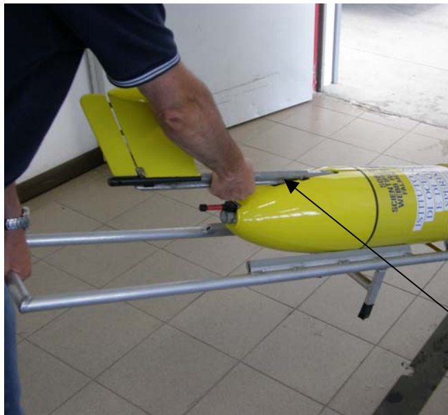
Fig. 4 Durante le fasi di recupero o di rilascio, afferrare saldamente il Glider per il Braccio metallico del timone.
