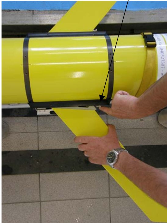
Fig. 13 e 14 Sgancio e aggancio delle ali (Wings). Le ali vanno montate poco prima di entrare in acqua e smontate durante il recupero, prima di issare a bordo il Glider. Durante queste operazioni prestare attenzione a non urtare i sensori (Fig. 6) sotto l'ala.
