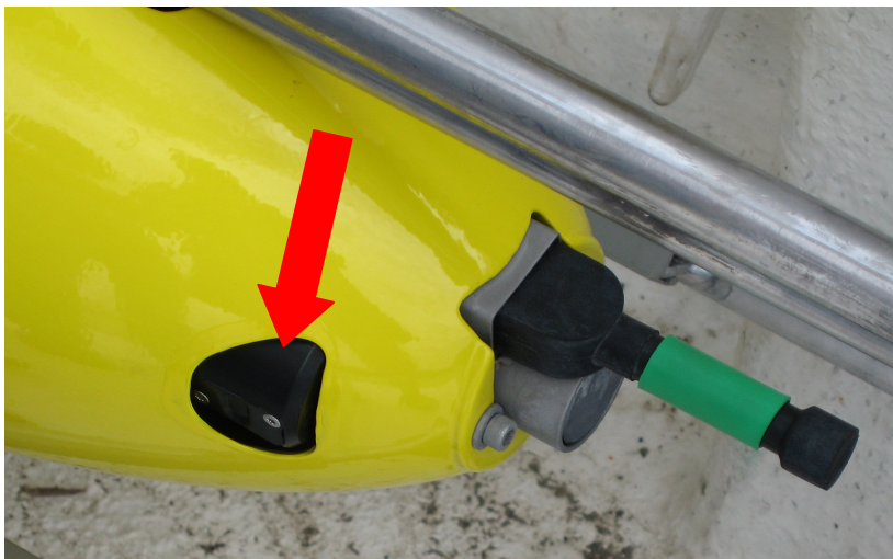
Fig. 4. Il sensore che rileva l'ossigeno (Aanderaa Optode 3835) posto nel cono di coda del Glider.
