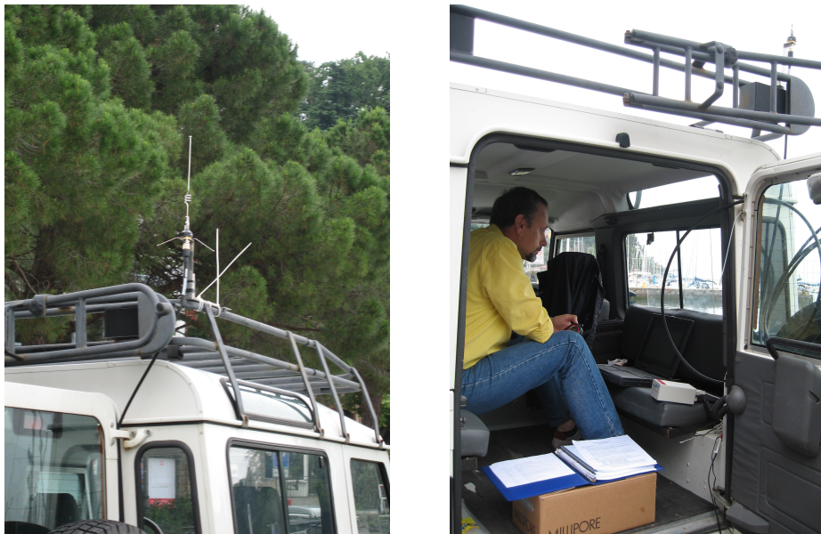
Fig. 8. Postazione mobile con antenna freewave e terminale per comunicare con il Glider.
