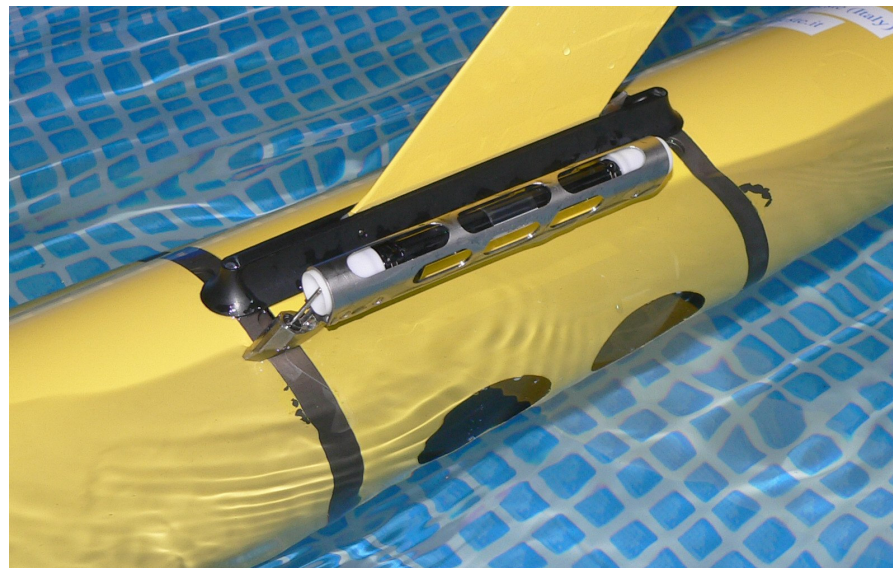
Fig. 2. Il CTD Sea-Bird posto sotto l'aletta di dritta ed i sensori ottici (fluorescenza e torbidità) della Wetlabs situati sul ventre del Glider.
